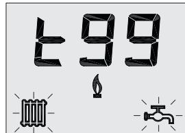
Appuyer les touches «Sanitaire +» ou «Sanitaire -» simultanément pendant 5 secondes pour sortir du mode TEST.
