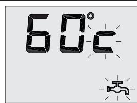
Sélection de la température eau chaude en appuyant les touches "Sanitaire +" et "Sanitaire -" (11 et 12).
