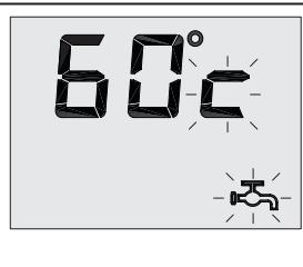
Instellen van de temperatuur van warm water met behulp van de toets "Sanitair +" en "Sanitair -" (detail 11 en 12).
