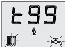
Druk gedurende 5 seconden tegelijkertijd op de toets "Sanitair +" en "Sanitair -" om de TEST-modus te verlaten.
