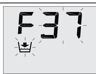
**N.B. :** Si la pression hydraulique descend en-dessous du seuil minimum de fonctionnement, l'afficheur indique l'anomalie **F37** clignotante avec le symbole (7). Une fois rétablie la pression hydraulique nominale, l'anomalie s'efface automatiquement.
