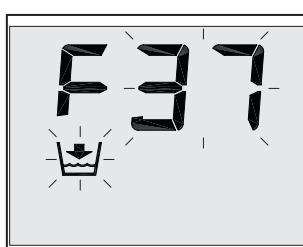
N.B. Wanneer de hydraulische druk in de installatie minder dan de minimumdrempelwaarde voor de werking bedraagt begint op de display storing F37 te knipperen met het betreffende symbool (detail 7). Wanneer de nominale hydraulische druk weer hersteld is verdwijnt de storingsmelding automatisch.
