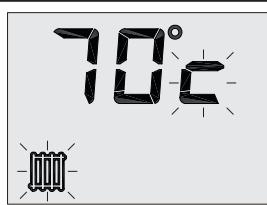
Sélection de la température installation de chauffage par les touches "Chauffage +" et "Chauffage -" (9 et 10).
